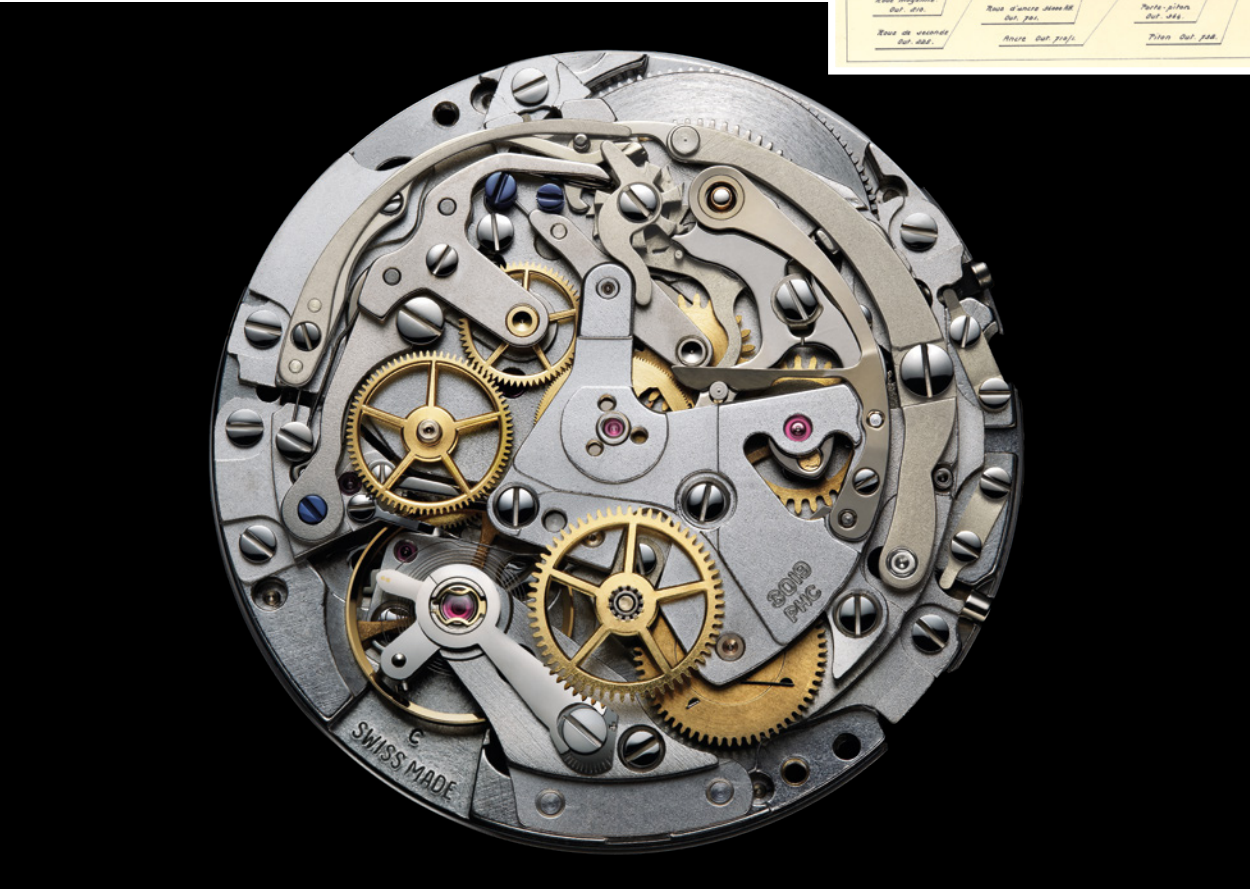
Automatisches Chronographenwerk 3019 PHC Zenith El Primero, 1969
